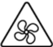
Ce symbole indique la présence d'un ventilateur avec des pales en mouvement. Elles posent un risque de blessures en cas de contact.
